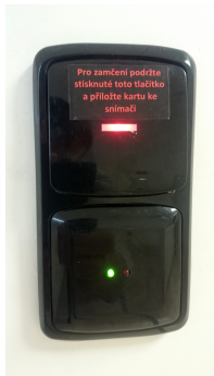
Kombinace čtečky karet, ovládacího tlačítka a signalizace
