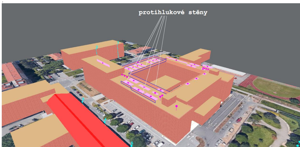
Obr. č. 13 situační snímek protihlukových clon
