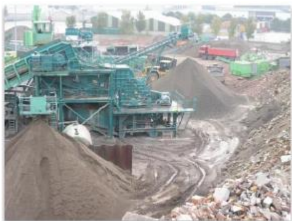
Zařízení na recyklaci stavebních a demoličních odpadů, Zdroj: FIR
