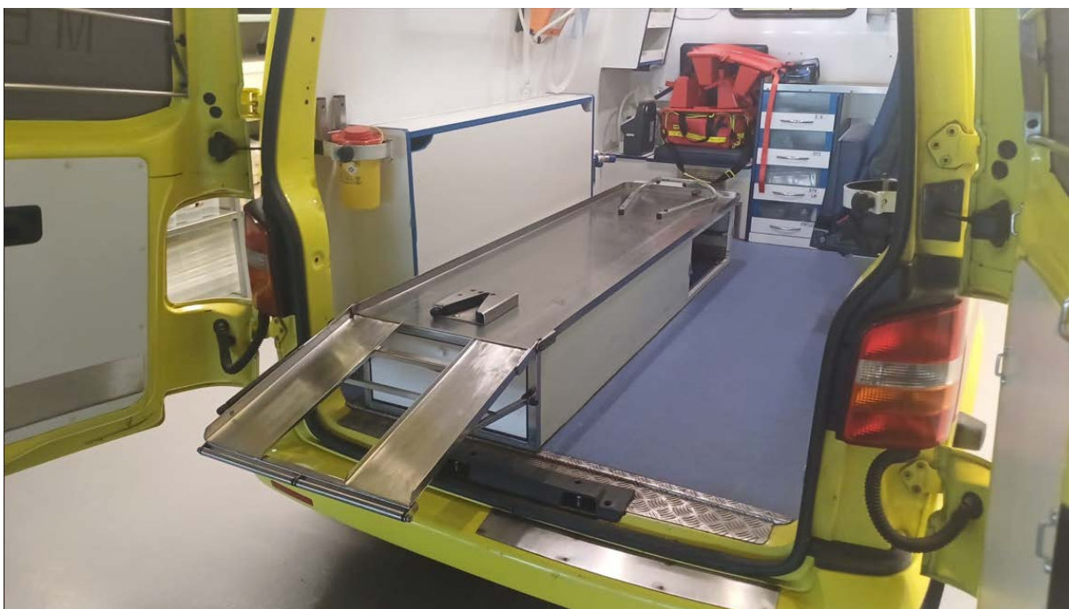
Obrázek 1 a 2 - Foto stolu nosítek simulované sanitky zadavatele
