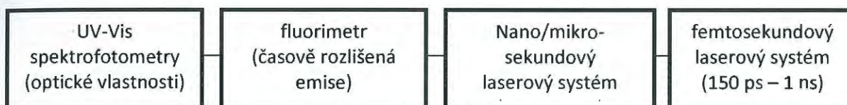
Obrázek 1. Systém laserové zábleskové fotolýzy
