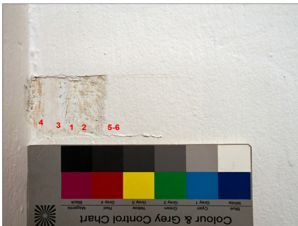
12) Sonda vlevo, stěna u prostředního okna nad dřevěným obložením. 1 - omítka; 2 - bílá líčka; 3 - okrová vrstva; 4 - 5 - fragmenty béžové a tyrkysové; 6 - vyrovnávací stěrka; 7 - současná povrchová úprava.
