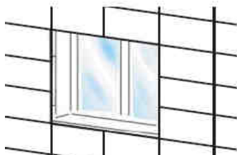
špatné lepení izolačních desek
