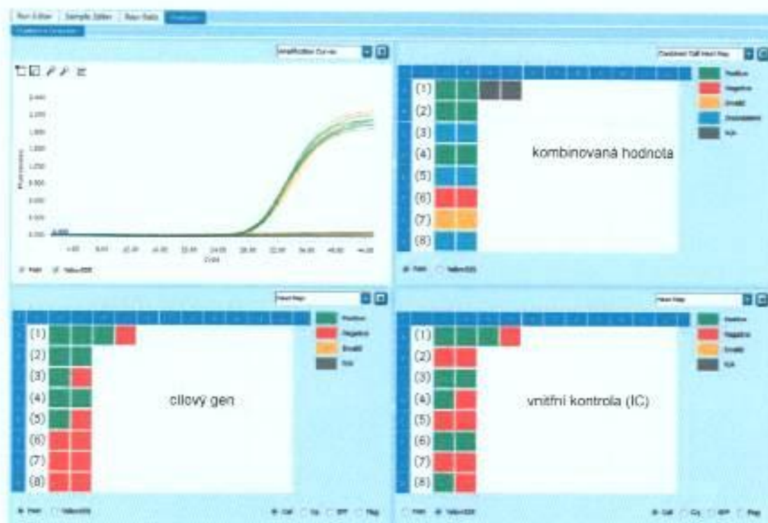
Obrázek 6: Modul detekce kvality poskytuje kombinované hodnoty získané z hodnot amplifikace cílových genů a vnitřní kontroly.
