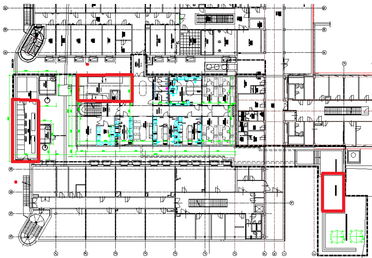
Obr. 1 Půdorys 1PP – strojovna VZT, umístění náhradního zdroje a venkovních jednotek
