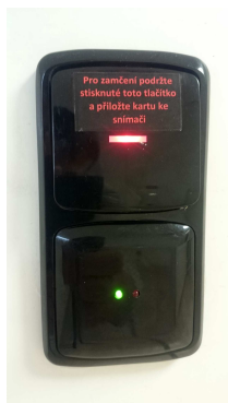
Kombinace čtečky karet, ovládacího tlačítka a signalizace
