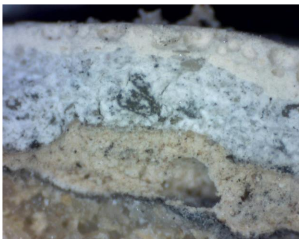
Vzorek E – výstavba povrchových úprav korintské hlavice polosloupu zhotovené z pískovce při makroskopickém zvětšení.
