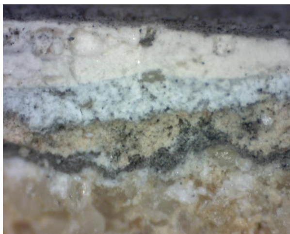
Vzorek E – výstavba povrchových úprav korintské hlavice polosloupu zhotovené z pískovce při makroskopickém zvětšení.
