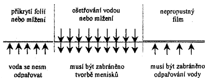
Graf smrštění a ošetřování betonu
