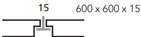
osazení panelu na profil
