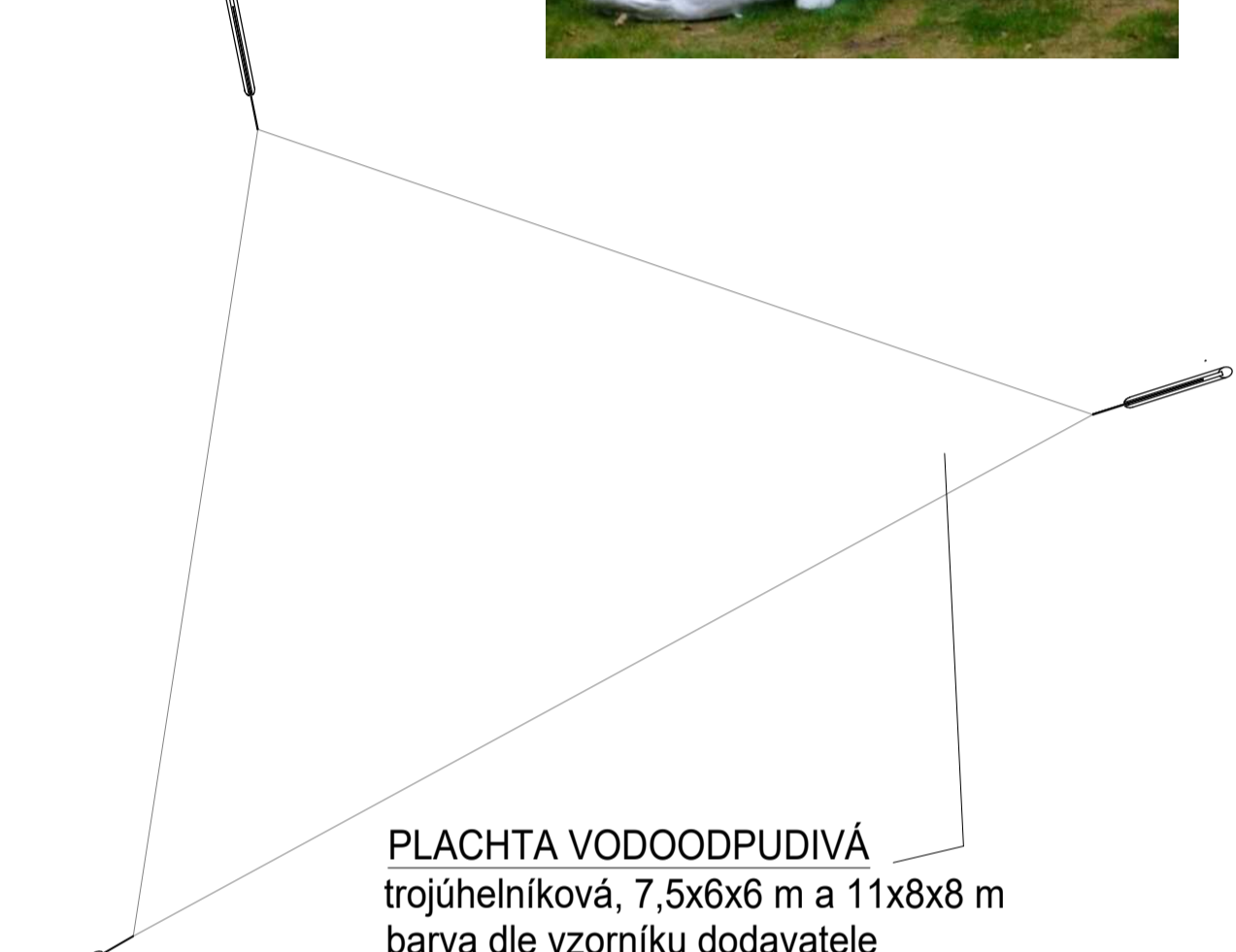
PLACHTOVÉ ZASTÍNĚNÍ (PROTI DEŠTI) M 1:20 KÓTOVÁNO V mm
